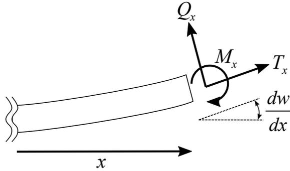
図3 たわみによって回転した切断面にかかる荷重
